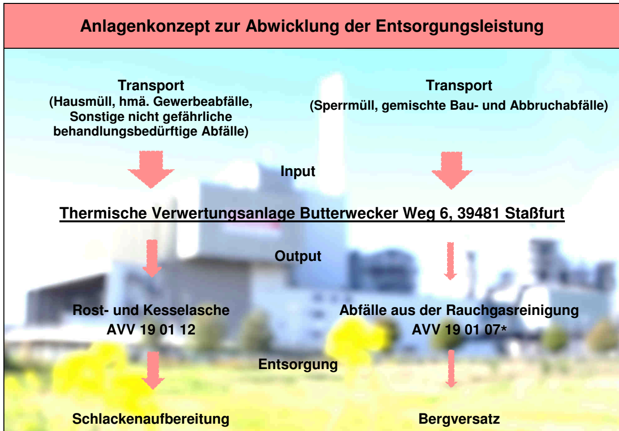
Abbildung 8: Anlagenkonzept zur thermischen Abfallentsorgung
