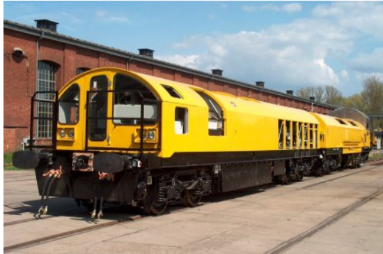
Neuentwickelter Fräßzug der Fa. GBM GmbH für die Londoner U-Bahn
