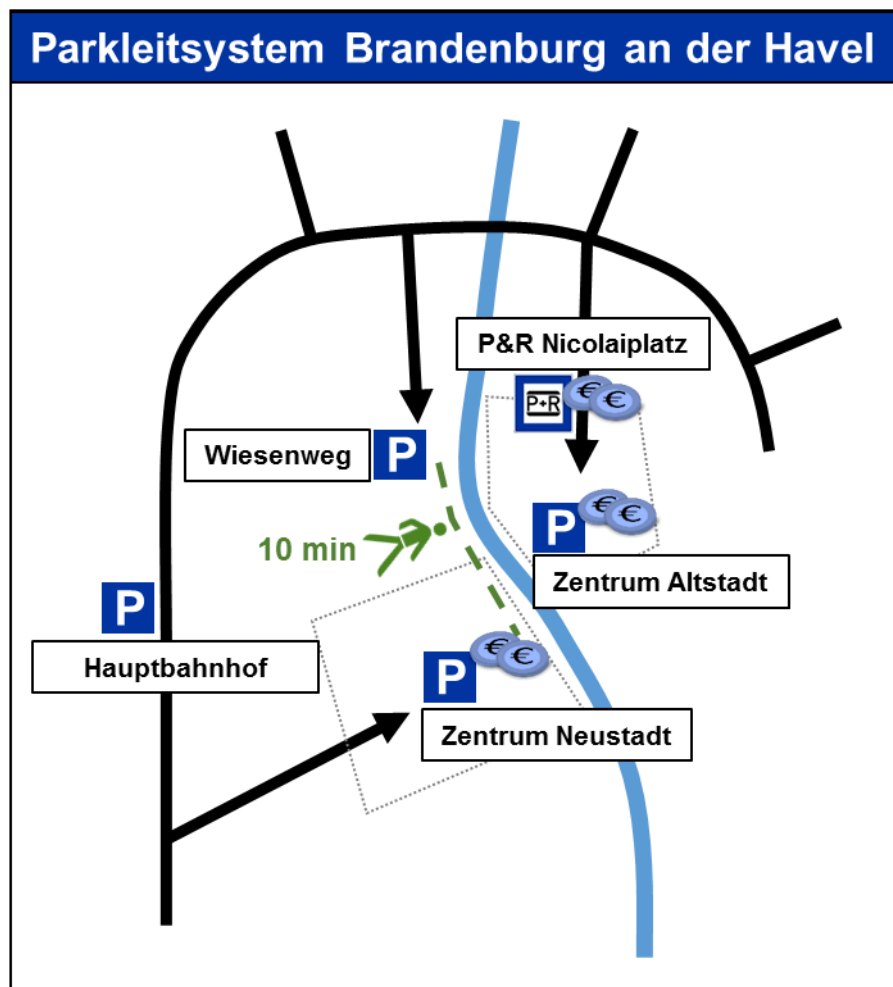
Grafik 18: Beispielhafter Entwurf eines Vorwegweisers für den Standort Potsdamer Straße
