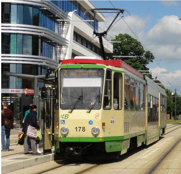
Foto: Straßenbahnwagen Tatra KTNF6 (Baujahr 1981) mit Niederflurabteil in der Wagenmitte
